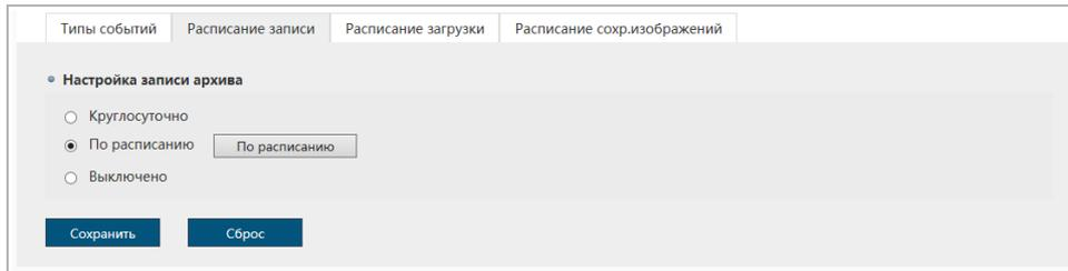
Выберите **План записи [Record Plan]** видеопотока на установленную SD-карту (см. раздел 3.3.5.1):
