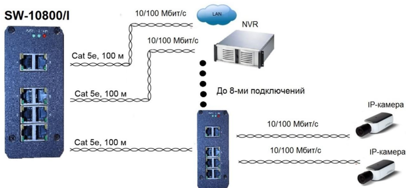
Рис. 18 Структурная схема подключения коммутатора SW-10800/I
