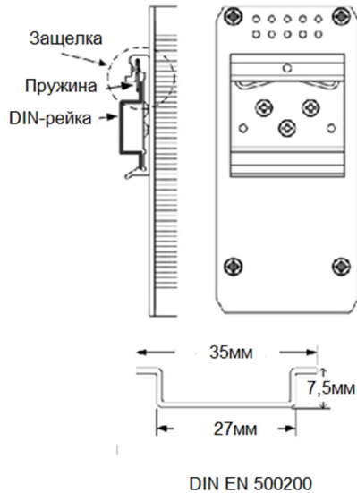
Рис.7 Крепление SW-10800/I на DIN-рейку
